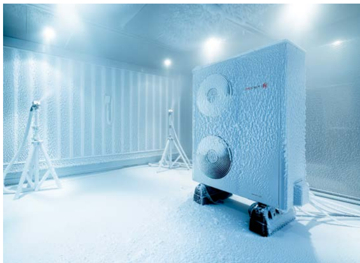
Odolnost vůči extrémním povětrnostním podmínkám je v naší klimatické komoře maximálně testována.
